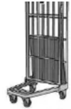
【U字型ロールボックスパレット】 折りたたんで収納する際、ショッピングカートのごとく収納できるように、前部のキャスターの間隔が後部のキャスターの間隔よりも短くなっている
