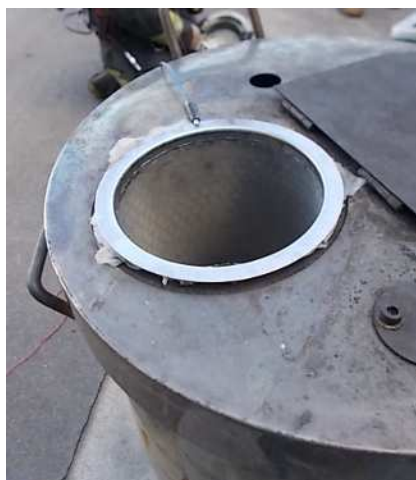
フィルター設置状態
